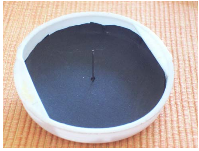
Рис. 4. Крышка с отверстием, готовая к установке (обратите внимание, насколько тщательно края картона приклеены черной изолентой).
