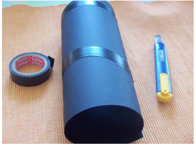
Рис. 8. Труба из чёрного картона готова к установке на фокусирующий экран для дополнительной защиты от солнечного света.
