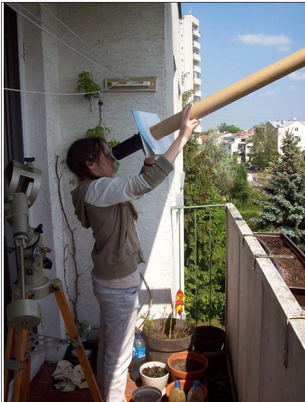
Рис. 10. Наблюдения. Наведите отверстие на Солнце и смотрите на его изображение на фокусирующем экране.
